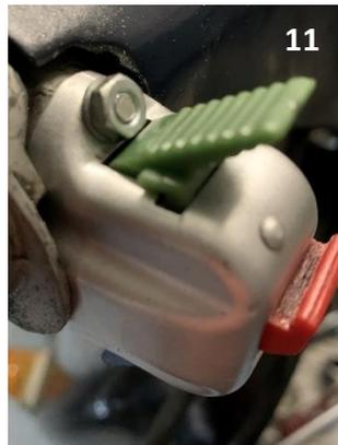
Da das Eindrehen der Befestigungsschraube zu einer Kollision des Schraubendrehers mit dem Hupenknopf führte, verwendete ich einen kurzen Gewindebolzen mit Mutter.
